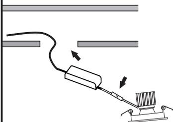
Após ligar o driver conecte os cabos da luminária e coloque-o dentro do forro
