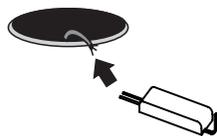
Com a rede elétrica desligada, ligue os cabos do driver
